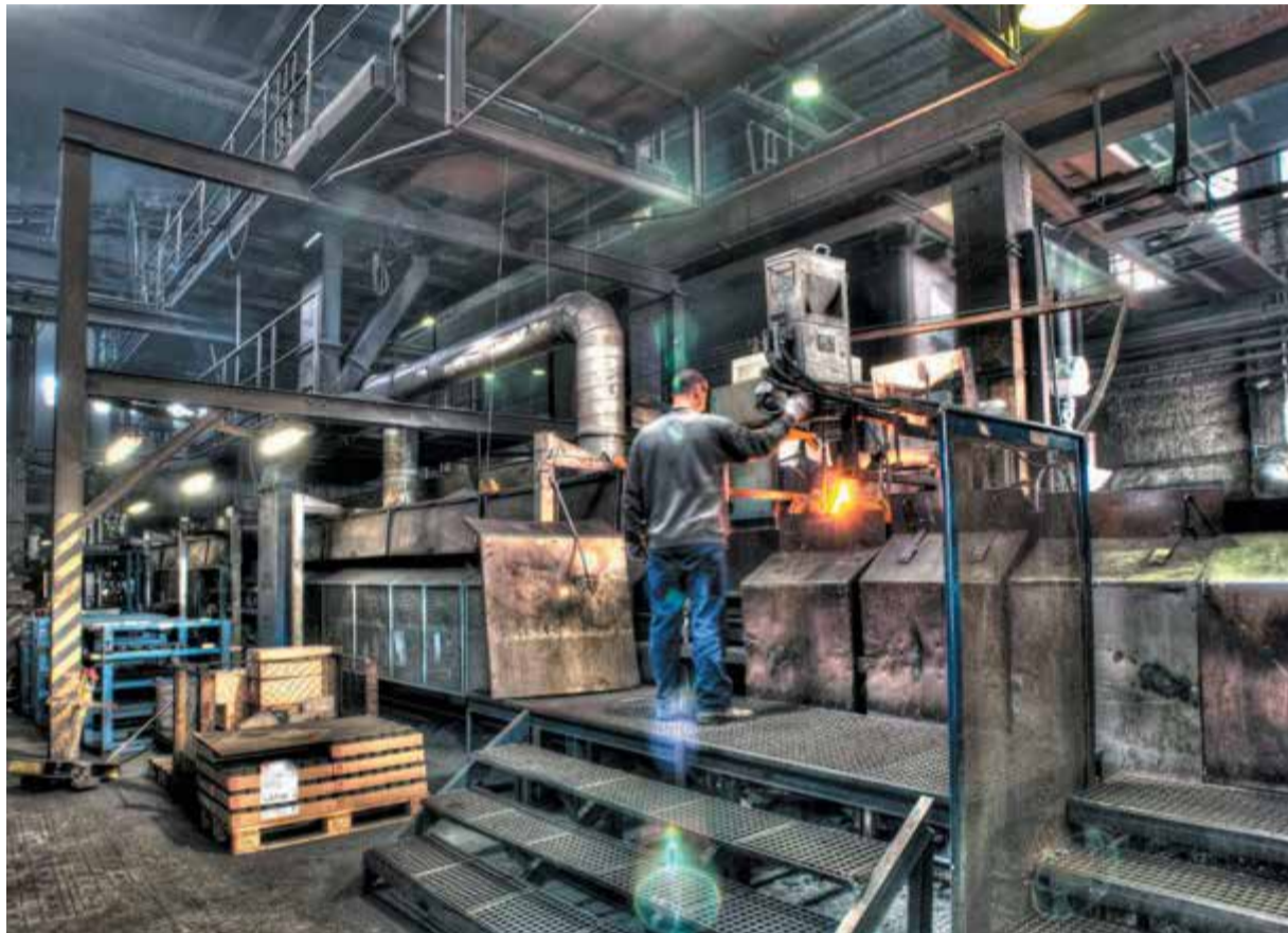
Srdcem divize Slévárna litiny MOTORU JIKOV Slévárna a.s. je formovací linka DISAMATIC
