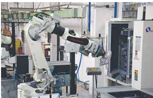
Automatizovanou výrobní buňku tvoří dvě horizontální obráběcí centra MAKINO a61, stanice pro odjehlení, stanice pro montáž závitových vložek a nýtů. S odlitky ve výrobní buňce manipulují dva roboti Kawasaki. Součástí dodávky automatizované výrobní buňky je i samostatně stojící komorová pračka Kraintek.
