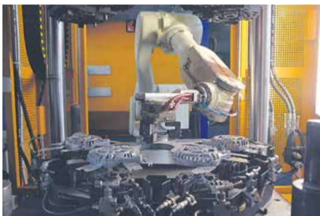
Vyjímací robot Kawasaki na snímku umísťuje odlitky do ostřihovacího stroje Diesse Presse.
