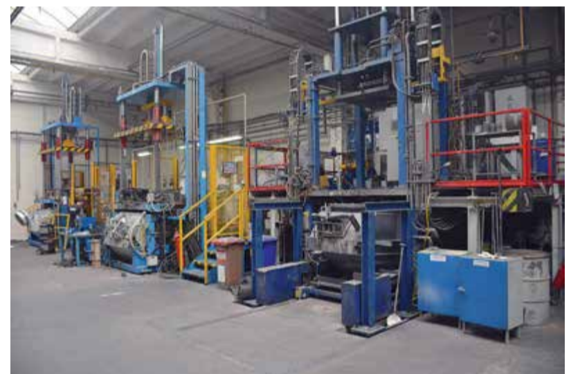
Nový nízkotlaký licí stroj LPM BPS 800-SX (vlevo) rozšířil v zářích kapacity nízkotlakého lití MOTOR JIKOV Slévárna a.s.
