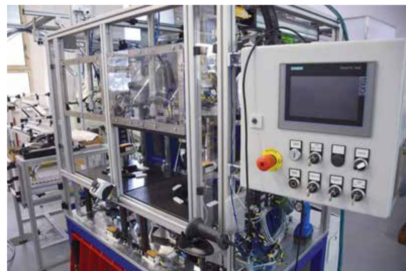
Plně automatický jednoučelový stroj, který ověřuje sto procentní funkčnost dílce a prověří osazení všemi komponenty, je součástí montážní linky kliky dveří vytvořené v divizi Jednoučelové stroje MOTOR JIKOV Fostron a.s.
