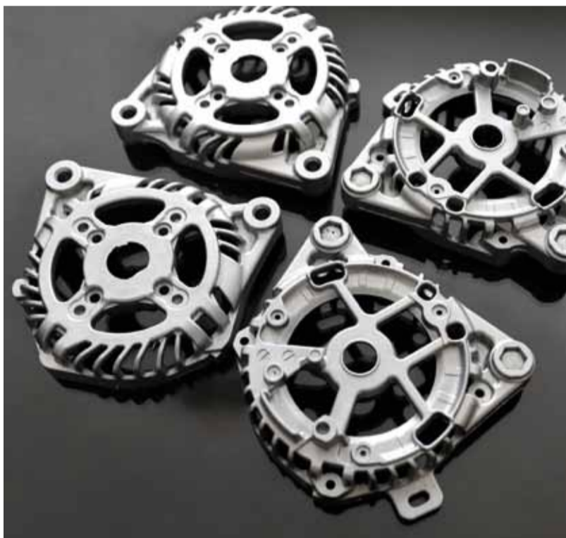
První testovací odlitky tělesa alternátoru
