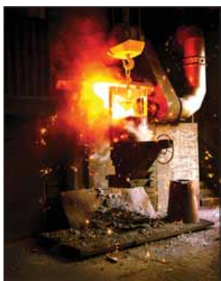
Pulsujícím srdcem slévárny litiny jsou tavicí pece
