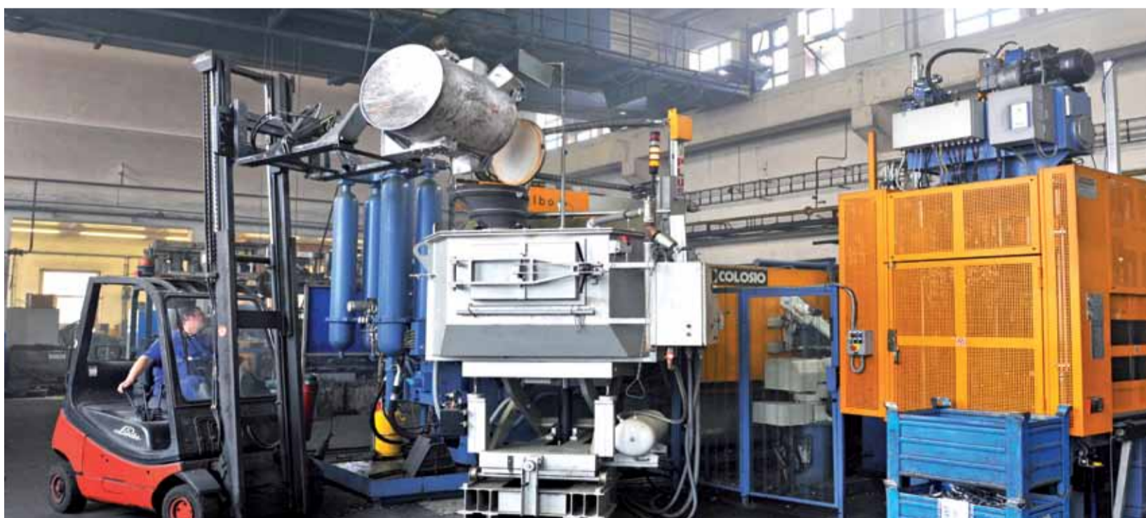
MOTOR JIKOV investuje do vývoje: Hi-tech robotizované pracoviště Colosio PFO 560 v divizi Tlaková slévárna společnosti MOTOR JIKOV Slévárna a.s.
