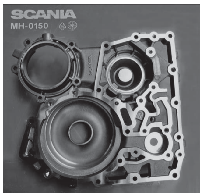
Retarder Housing - díl převodovky kamionu
