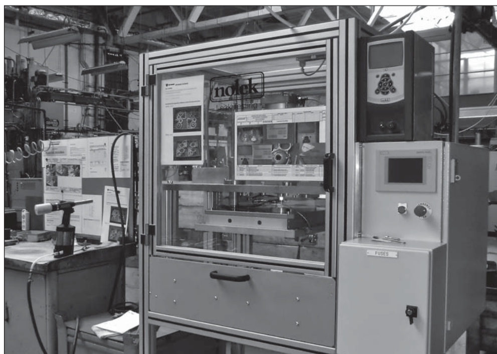
Zařízení od firmy NOLEK pro tlakové zkoušky těsnosti dílců
