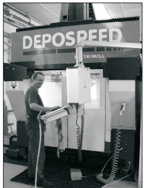
MOTOR JIKOV FOSTRON a.s. má ve svých provozech nové zařízení. Jedná se o výsoce výkonné obráběcí centrum od zlínského výrobce TRIMMILL, které společnost využívá zejména k obrábění rámů forem.
