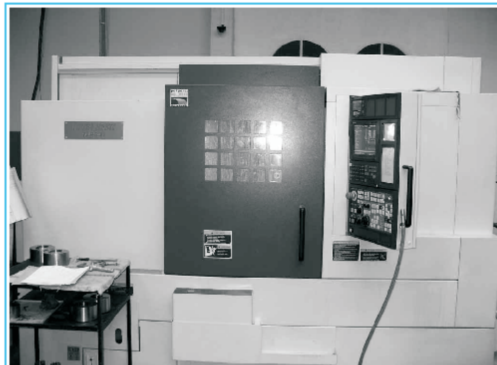
CNC soustruh MORISEKI je určený pro obrábění přesných rotačních dílců přírubového typu s možností opracování i mimo osu. Je vybaven protřísňovanou a poháněnou nástroji. Se záměrem zvýšit produktivitu práce a odstranění následného opracování byl do divize Zakázky instalován koncem loňského roku, nyní je již v plném provozu.
