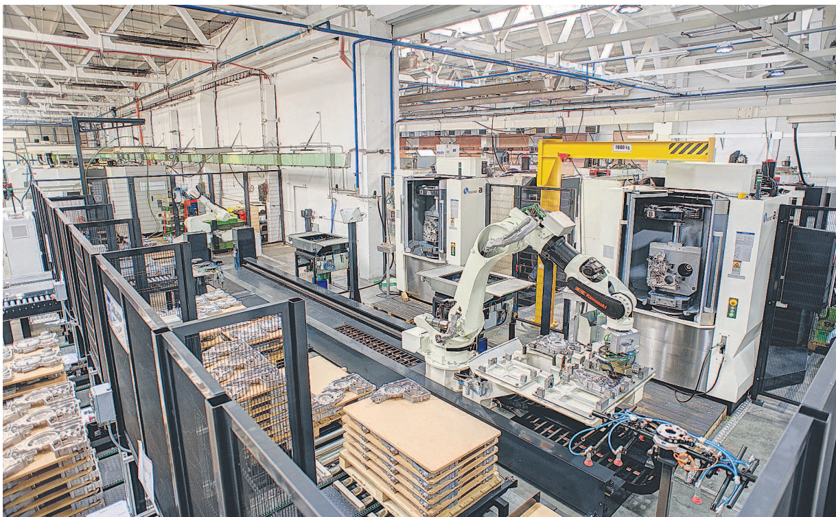
Největší loňskou investicí v rámci společnosti holdingu MOTOR JIKOV GROUP byla za šedesát milionů korun automatizovaná výrobní buňka, kterou tvoří dvě horizontální obráběcí centra MAKINO a61, stanice pro odjehlení, stanice pro montáž závitových vložek a nýtů. S odlitky ve výrobní buňce manipulují dva roboti Kawasaki.
