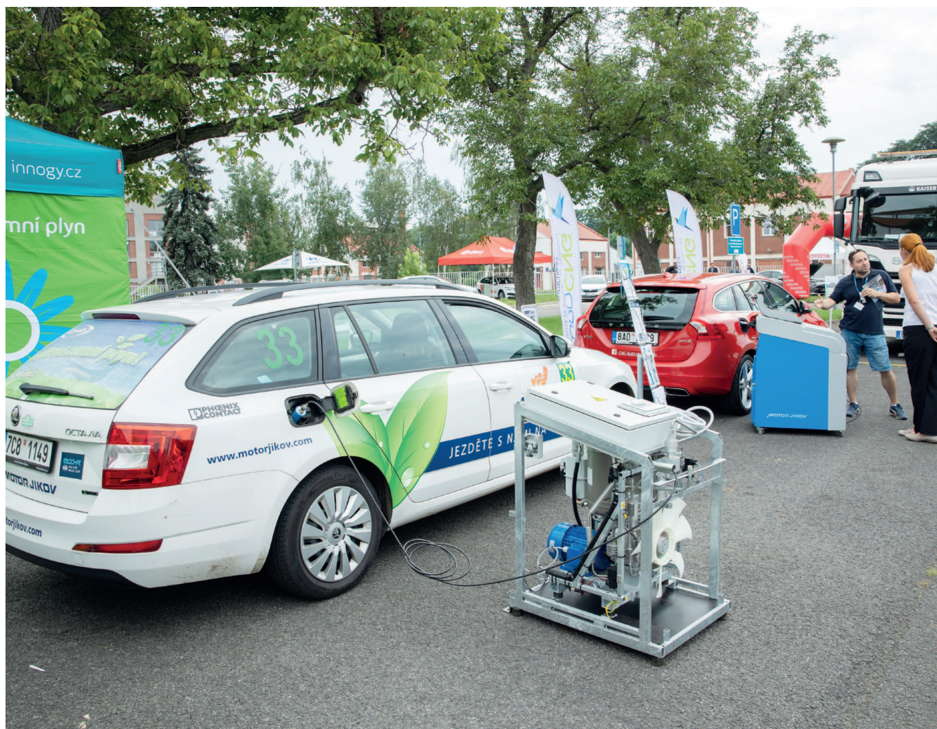
MOTOR JIKOV Strojírenská a.s. prezentovala na Dni plynové mobility snadné plnění stlačeného zemního plynu i v domácím prostředí pomocí plničky CNG MJ Compact 05.
