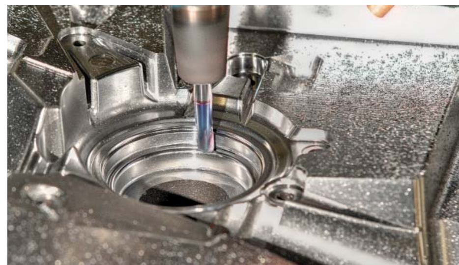
Obrábění formy, foto: Motor Jikov Group
