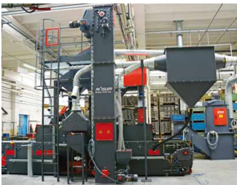
Instalace průběžného tryskače v hale hrotovny začala na konci února. Tryskač bude primárně sloužit na nové výrobní projekty pro firmu Mitsubishi. „Zařízení v postupných krocích využijeme i pro jiné projekty a tryskání stávajících výrobků, mezi které patří především odlitky válců pro firmu Mahle a celá skupina odlitků pro firmu Scania,“ doplnil Tomáš Prášil. Průběžný tryskač je pořizován v rámci projektu Rozšíření technologického výrobního centra (TVC), Programu Potenciál Operačního programu podnikání a inovace.
