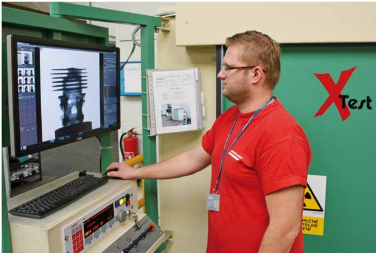
V rámci investice do rozšiřování technologického výrobního centra pracují na Tlakové slévárně od loňského září s novým rentgenem. „Slouží například pro objemovou kontrolu vnitřních vad, zjistíme díky němu, jestli jsou naše výrobky ve shodě s požadavky zákazníka,“ uvedl kontrolor jakosti Tomáš Hájíček (na snímku).
